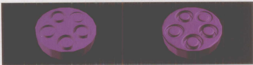
► 左边为原始对象，右边为使用了“四边形网格化”和“网格平滑”修改器后的效果
