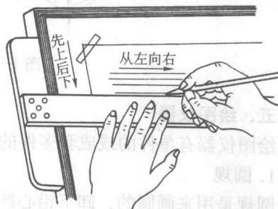
图 1—2 用丁字尺画水平线
