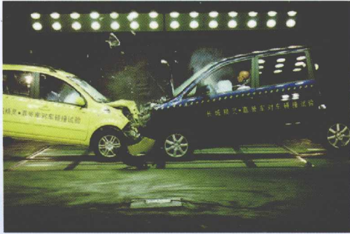
车与车正面碰撞试验
