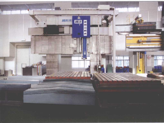
● XH21工作台自动交换系列动梁龙门加工中心（图为XH2125×40型产品）
