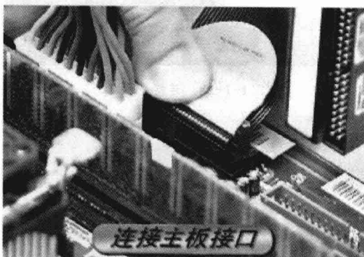
图 1-1-21 连接主板接口
