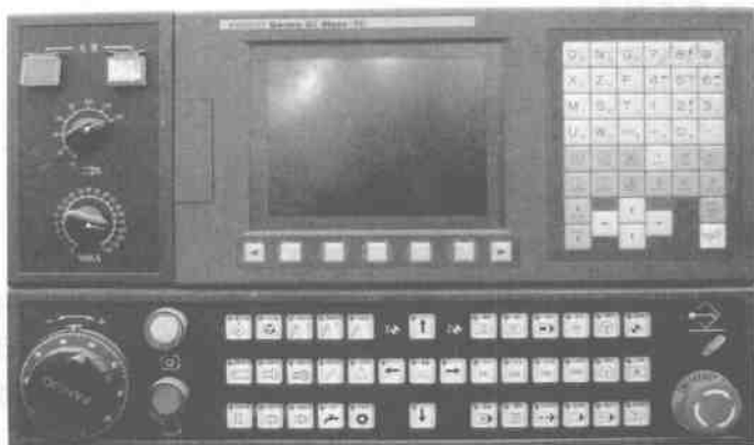
图 1-2 FANUC 0i Mate-TC 数控系统操作面板
