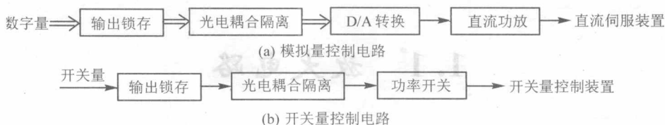
图 0-3 控制电路的类型与基本组成
