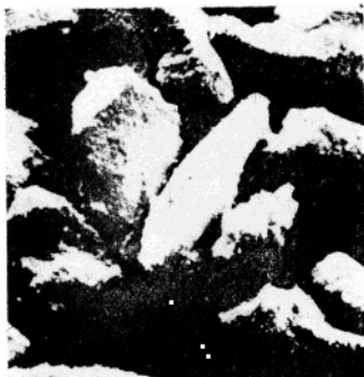
80/100US mesh, 特殊銅合金50%重 量包覆的人造鑽石磨料
