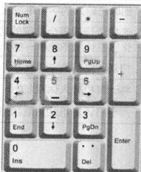
数字键区的作用是将数字及运算符快速地输入，输入数字时，需先按下“Num Lock”键，在指示灯亮的情况下才能输入，而在数字键指示灯不亮的情况下按下相应按键后，可以控制光标的状态。
