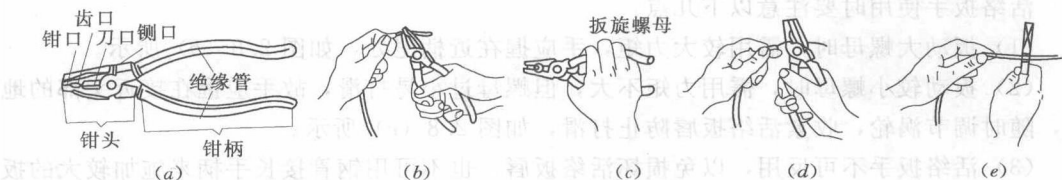
图 2.5 电工钢丝钳的构造及用途
