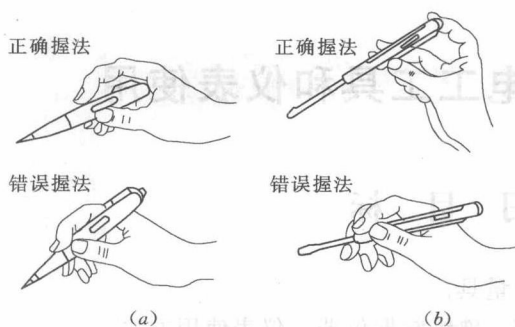
图 2.2 低压验电器握法 (a) 钢笔式握法；(b) 螺丝刀式握法
