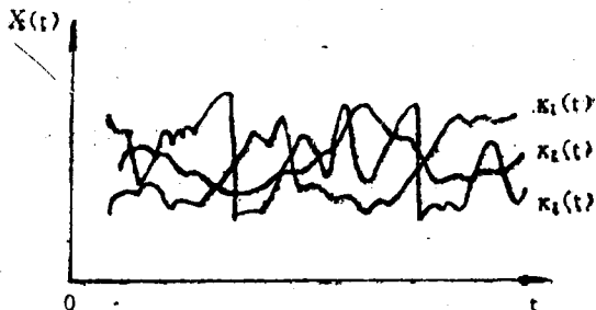
图2-1 噪声电压的起伏波形
