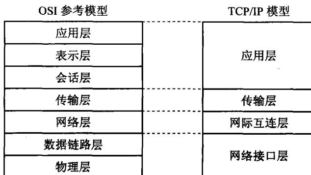
图 1-5 OSI 模型与 TCP/IP 模型结构对照
