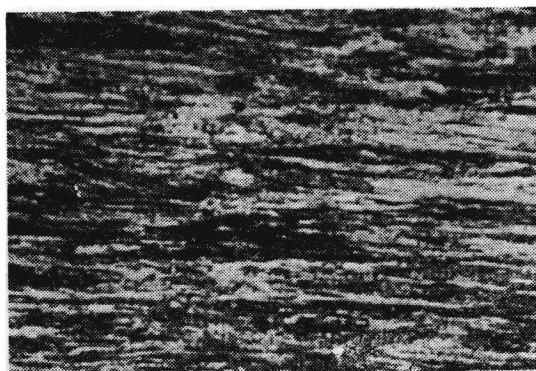
图11 盐浴等温处理成品钢丝的金相组织变形索氏体 ( \times 600 )
