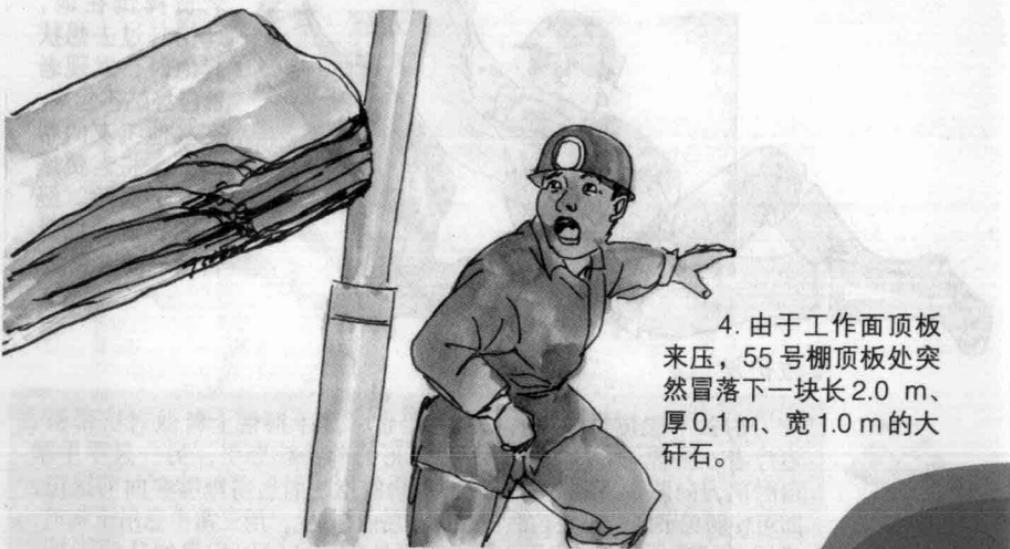
4. 由于工作面顶板来压，55号棚顶板处突然冒落下一块长2.0 m、厚0.1 m、宽1.0 m的大矸石。
