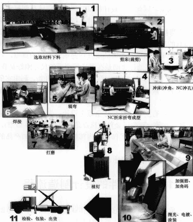
图 1-4 钣金件制造流程
