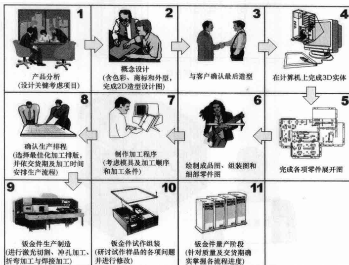
图 1-3 钣金件设计的流程
