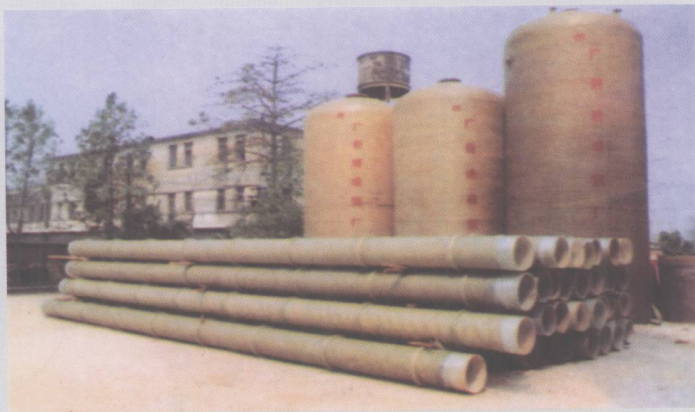
1989年广州玻璃钢厂引进生产线，生产出具有90年代国际先进水平的纤维缠绕玻璃钢贮罐及管道系列产品。
