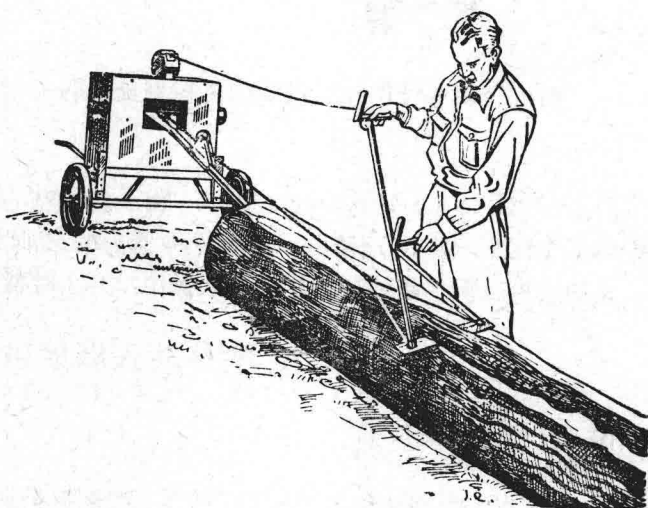
图3. 刮刀由钢索牵引的《VIGNEAN—VALENTIN》型剥皮机
