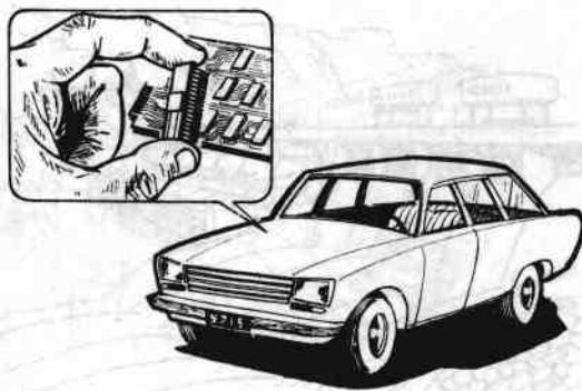
22. 计算机发展到今天，微处理机已大量生产，广泛使用。它们具有体积小，重量轻，可靠性高，价格便宜等特点。它可用于汽车的控制，调节点火时间和点火控制系统。汽车装了这种系统后省油百分之十，因为微处理机能使发动机始终工作在最佳状态。它也可以做成防止横滑的电子刹车装置和电子式变速器，保证安全行车，合理利用时间。
