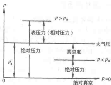
图 1-3 绝对压力、表压力与真空度之间的关系
