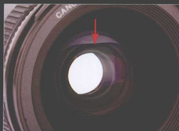
▲EF 24mm f/1.4L USM也加入光斑遮挡叶。
