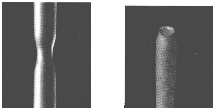
图 2-3 拉断前后的试件
