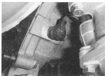
图 3001-1-1 曲轴位置传感器安装位置
