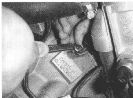
图 3001-1-5 松开曲轴位置传感器的紧固螺钉
