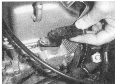
图 3001-2-5 拔下凸轮轴位置传感器连接插头
