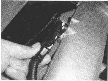
图 3001-3-3 拔下进气压力温度传感器插头
