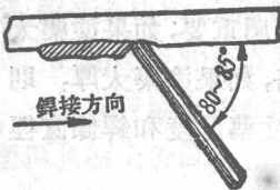
圖24 仰焊時焊條的位置
