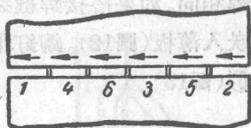
圖8 對接銲縫的銲接程序
