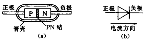
图 1-5 二极管的结构与符号 (a) 结构；(b) 符号
