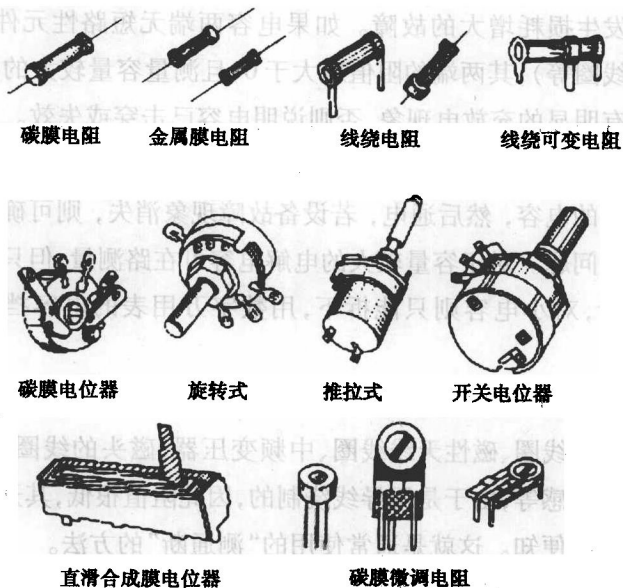
图 1.1 音频设备中使用的各种电阻和电位器
