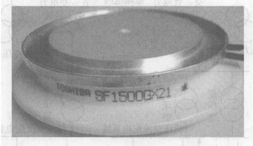
图 1-3 东芝 SF 系列平板型相控晶闸管
