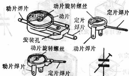
图1-5 瓷介微调电容器的外形及符号
