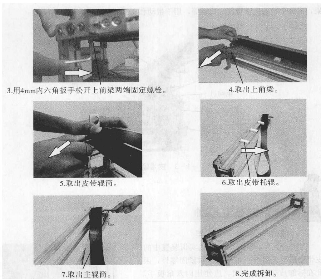
图 1-1-5 皮带输送机的拆卸方法与步骤
