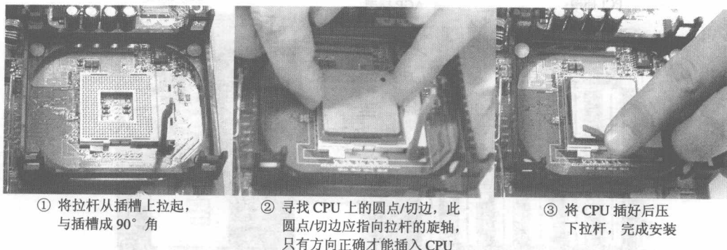
图 1.3 CPU 的安装
