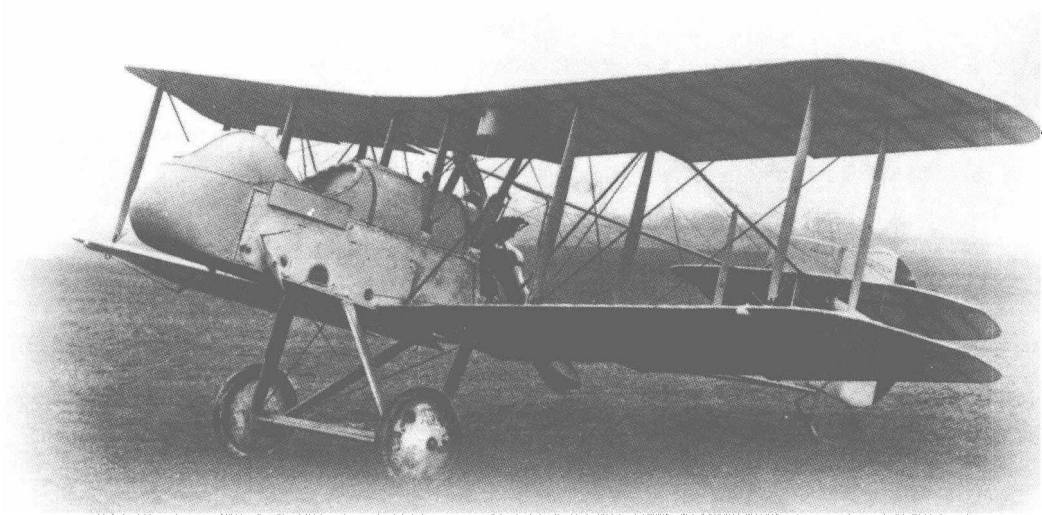
↑ DH.2 型是由杰弗里·德·哈维兰设计的一种单座推进式侦察机。1916 年 2 月，第 24 中队驾驶该型飞机抵达前线，并于 4 月 2 日取得首次胜利。
