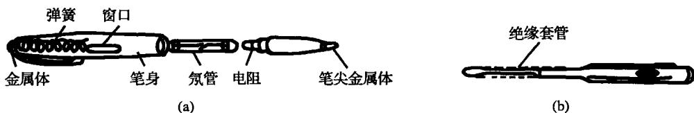
图 1-1 低压验电器 (a) 钢笔式; (b) 螺丝刀式
