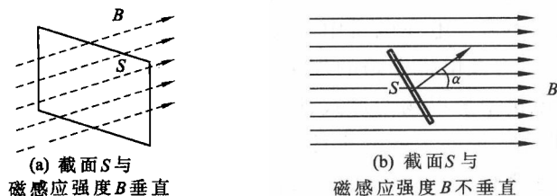
图 1-2 均匀磁场中通过某截面的磁通示意图
