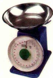
(a) 弹簧秤：50g/4kg 精度，称量 100g 以上的物料
