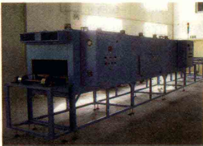
图1-3 工业化生产使用的隧道炉
