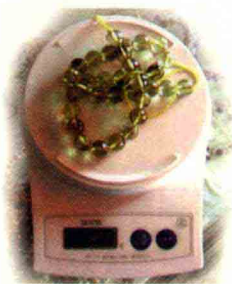
(d) 小型电子秤：精度达到 0.5g，称量 50g 以下的物料
