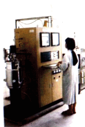
实验室 30 升全自动发酵罐
