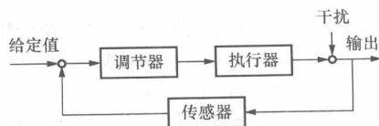
图 2-6 自动控制系统组成框图
