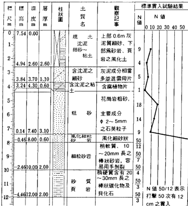
圖 2.2 土質柱狀圖（福岡市某處）
