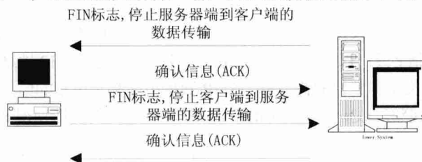
图 1.2 中断一个 TCP 连接的完整过程
