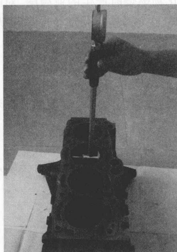
a. 测量气缸上部横向直径
