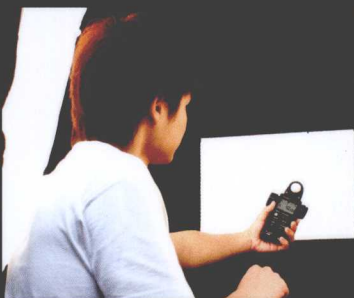
▲利用直射式测光表量度白纸四只边角及中央位置的光量是否相同。
