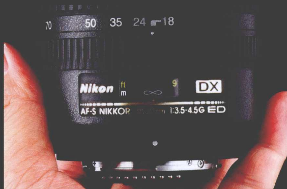
▲将镜头设定为手动对焦模式,并把焦点设定在无限远的位置之上。
