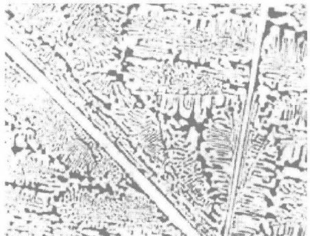
图 1-12 过共晶白口铸铁的室温平衡组织
