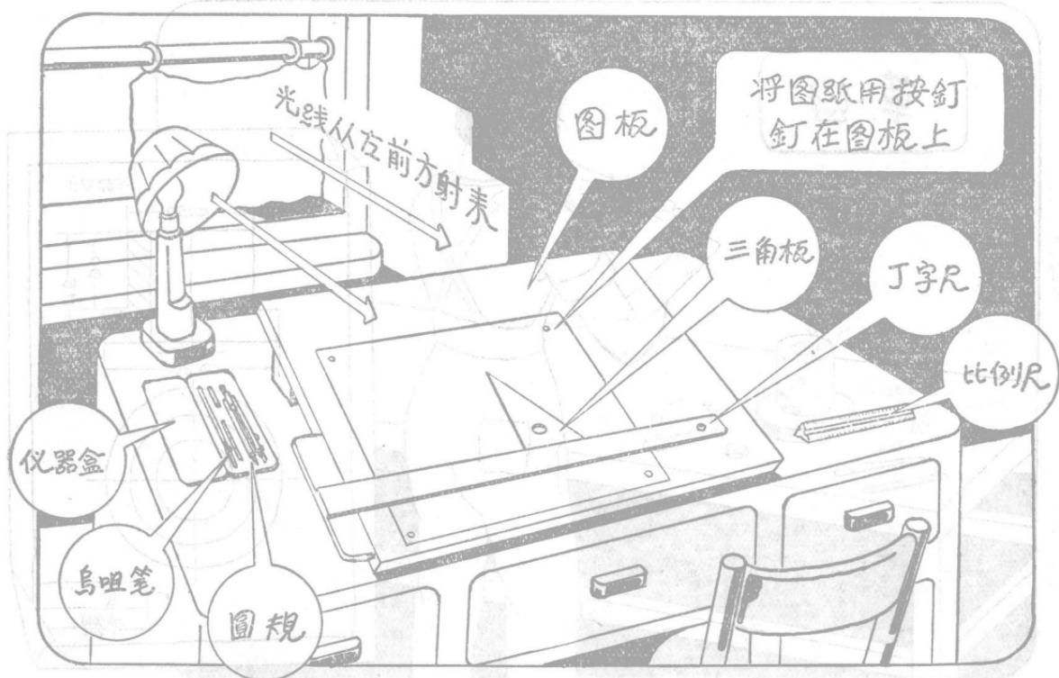
繪制工作圖時，通常用的工具：制圖板、丁字尺、三角板、曲線板、制圖鉛筆、制圖儀器、比例尺等。繪制工作圖時，應使光線從左前方射來，把丁字尺頭部放在制圖板的左边，使其能來回滑動。
