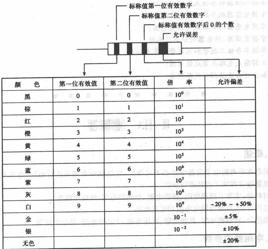
图 1-1 两位有效数字电阻值的色环表示法
