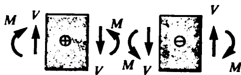
圖 1-2 剪力 V 和彎矩 M 的符號規定
