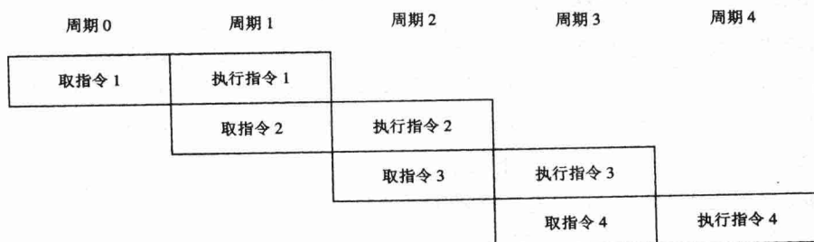
图 1-2 流水线结构工作示意图
