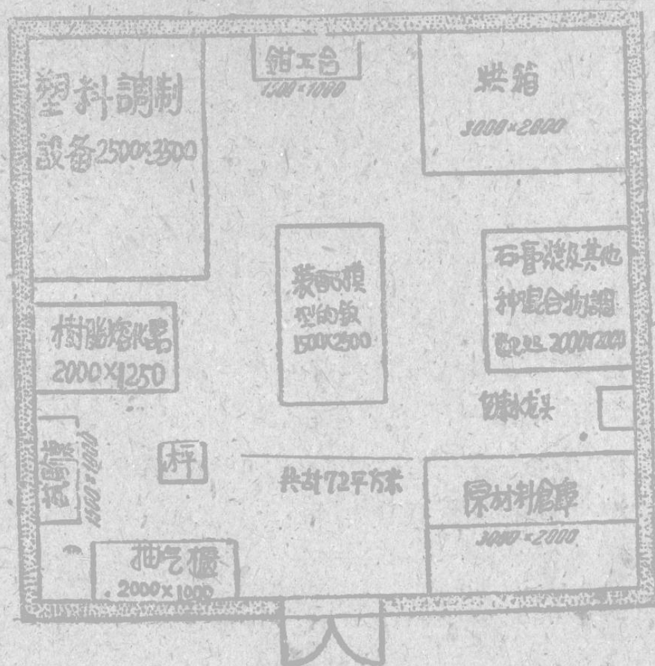
图16 塑料模具生产工段的典型平面布置图。
