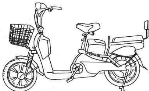
简易小轮型电动车（蓄电池中置式、后设小座椅）
