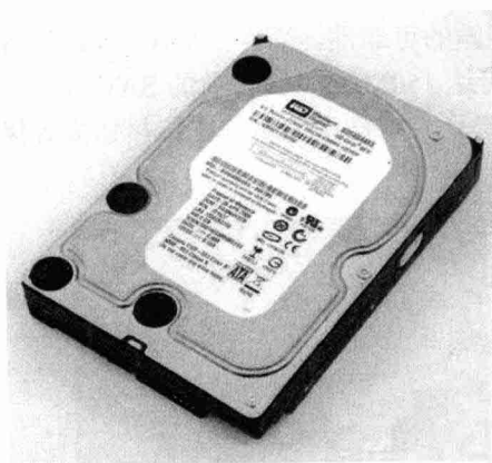
图 1-1 硬盘的外部结构
