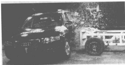
(a) 汽车的碰撞试验
