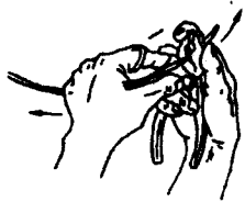
图 1-7 剥削导线绝缘层
