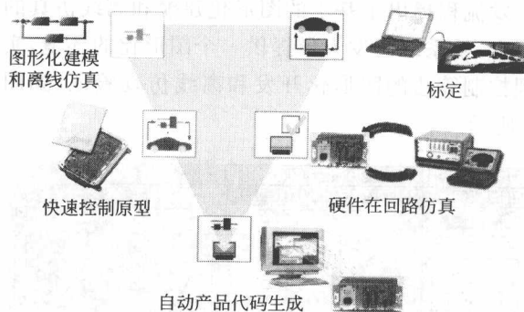
图 1 基于 V 模式的软件开发流程示意图
